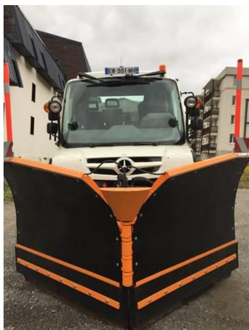
Le poids de l'étrave est ajustable, et de plus, cette dernière est bi-lame (caoutchouc et acier) permettant de mieux préserver les regards et autres éléments de voirie.
